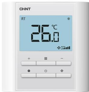
**TFP211L**是我司自主研发的一体式联网型风机盘管温控器，它集房间温控校正系数设定，环境温度设定，风机盘管运行方式设定以及时间计量功能于一身，通过采集高精度传感器信号与设定温度进行比较，根据设定的工作方式，输出控制信号，自动控制电动阀和风机，达到保持室内恒温的目的，适用于两管制的末端空调系统。具有LoRa通讯接口，配合LoRa网关可实现空调远程管理和计量计费等功能。
