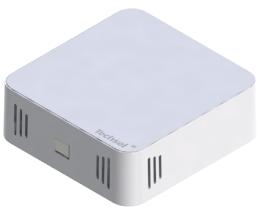
SITHCDP10/SITHCDP11是空气环境传感器产品之一，广泛应用于建筑智能楼宇工程中室内空气质量的CO<sub>2</sub>浓度及温湿度参数的实时监测，采用进口数字传感器，克服传统模拟式传感器不稳定、误差大、易受干扰、需定期校准等严重缺陷。同时具有采集精确可靠、外形小巧美观、防浪涌电压、无极性供电通讯等优点，广泛应用于商业办公、地铁、医院、图书馆等建筑环境控制场合。
