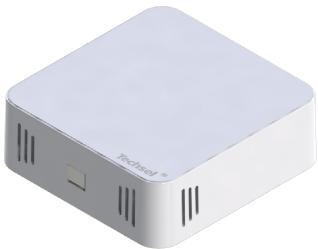
SAQ1B10是空气环境传感器产品之一，广泛应用于建筑智能楼宇工程中室内空气质量的温湿度参数、CO<sub>2</sub>浓度、PM2.5浓度、PM10浓度及VOC浓度、甲醛浓度参数的实时监测，采用进口数字传感器，克服传统模拟式传感器不稳定、误差大、易受干扰、需定期校准等严重缺陷。同时具有采集精确可靠、外形小巧美观、防浪涌电压、无极性供电通讯等优点，广泛应用于商业办公、地铁、医院、图书馆等建筑环境控制场合。
