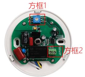
2、Switch (开关) (方框 2) 接通时间 2 秒以内恢复 (相当开关按键短按) , 触发控制继电器开关转换;
