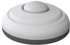
MO-IL01是SMC系列光照度传感器模块，广泛适用于农业大棚、城市照明等场所，具有测量范围宽、线性度好、适用方便、便于安装、传输距离远等特点，采用对弱光也有较高灵敏度的硅兰光伏探测器作为传感器。
